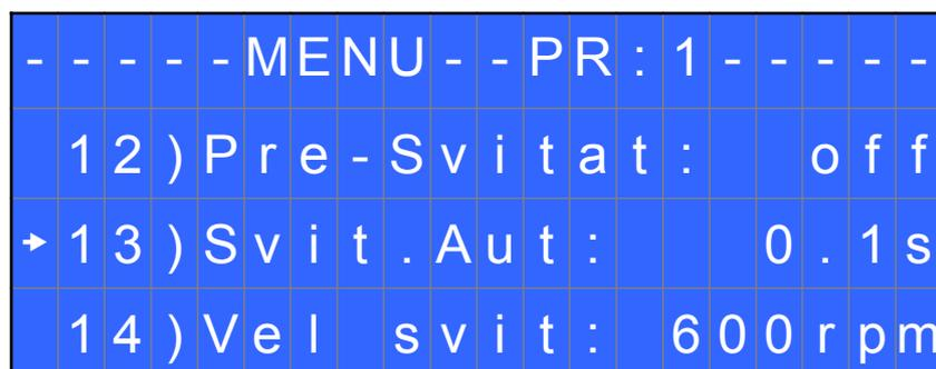
**12) Pre-Svitat. - Pre-svitatura.** Permette di svitare prima di eseguire l'avvitatura. Il tempo è impostabile da OFF a 20.0 sec.
