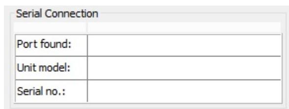
L'unità di controllo va connessa al pc tramite porta miniUSB o RS232 posti nel pannello posteriore. Se non fosse possibile individuare l'unità di controllo, assicurarsi che unità e pc siano collegati correttamente o che l'unità si trovi nella schermata iniziale del Menu.
