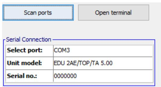
Quando nel riquadro “Serial connection” appariranno la porta, il modello dell'unità e il suo numero di serie, fare click su *Upload to unit*. Nel display dell'unità comparirà la scritta “Programming...”. Una volta finito il caricamento, la scritta scomparirà, il programma sarà caricato e sarà possibile scollegare il cavo.
