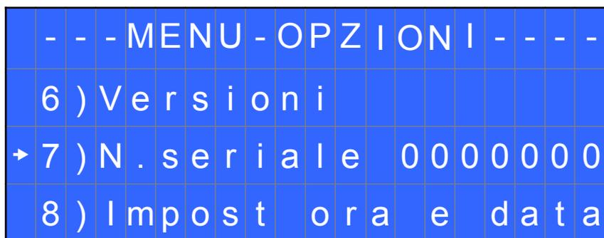
**6) Versioni:** in questa schermata è possibile visualizzare le versioni delle schede montate all'interno dell'unità.
