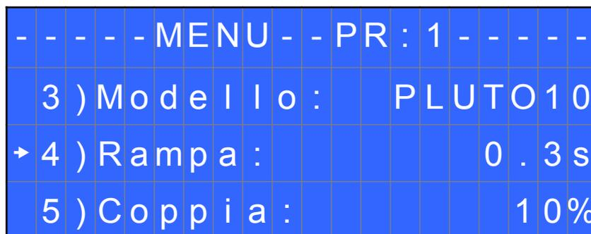
**3) Modello:** Permette di scegliere l’avvitatore utilizzato. La scelta cambierà automaticamente le impostazioni di default relative alla velocità e a tutti gli altri parametri dell’avvitatore. E’ importante impostare correttamente il modello che si andrà ad utilizzare in quanto molti parametri della gestione motore sono specifici per ogni singolo modello.
